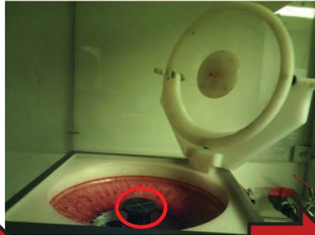
Se pone el sustrato el cual se le quiere depositar la resina, el vacío debe de estar fluyendo
