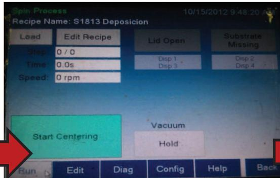
Ya cargada la receta solo falta cerrar la tapa y poner el sustrato Se posiciona el sustrato activando el vacío para sostenerlo, Presionar Hold
