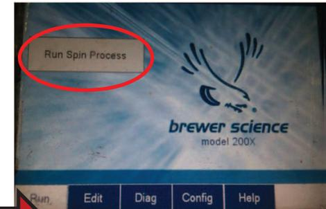
Esperar a que aparezca el Display del interfaz listo para usar y luego presionar «Run Spin Process»
