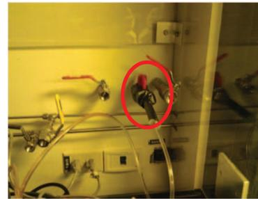
Abrir la palanca del vacío
